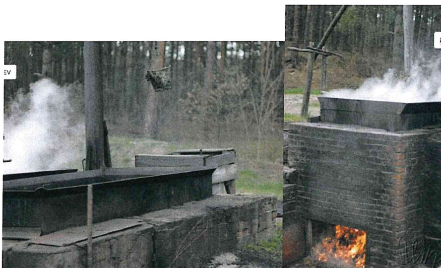
Rys. 2b. Przykładowa konstrukcja kotła do gotowania wikliny [3]
