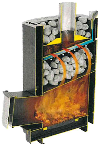
Rys. 5. Przykładowy pieca do sauny z zamkniętym zbiornikiem kamienia [4]
