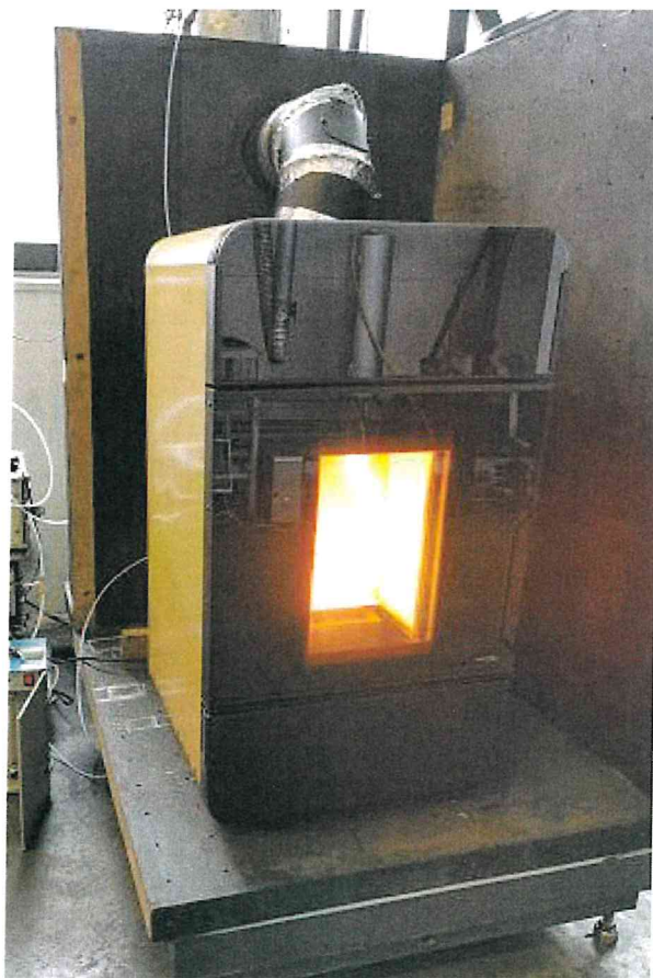
Rys. 1. Zdjęcie urządzenia grzewczego umieszczonego na narożniku pomiarowym [materiały własne ITPE]
