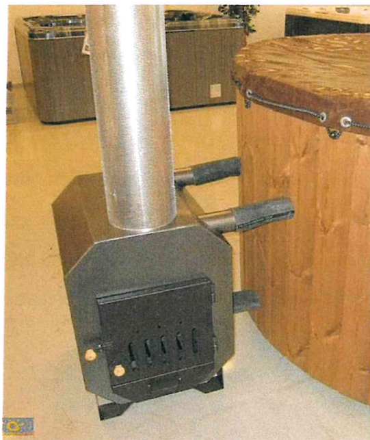
Rys. 10. Podłączenie pieca zewnętrznego do balii [10]
