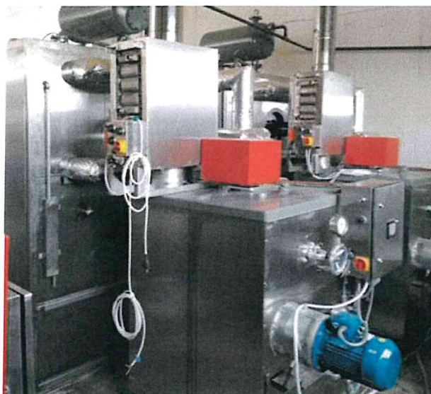
Rys. 17 Wymiennik ciepła o mocy 35 kW dedykowany do pieców piekarniczych [14]
