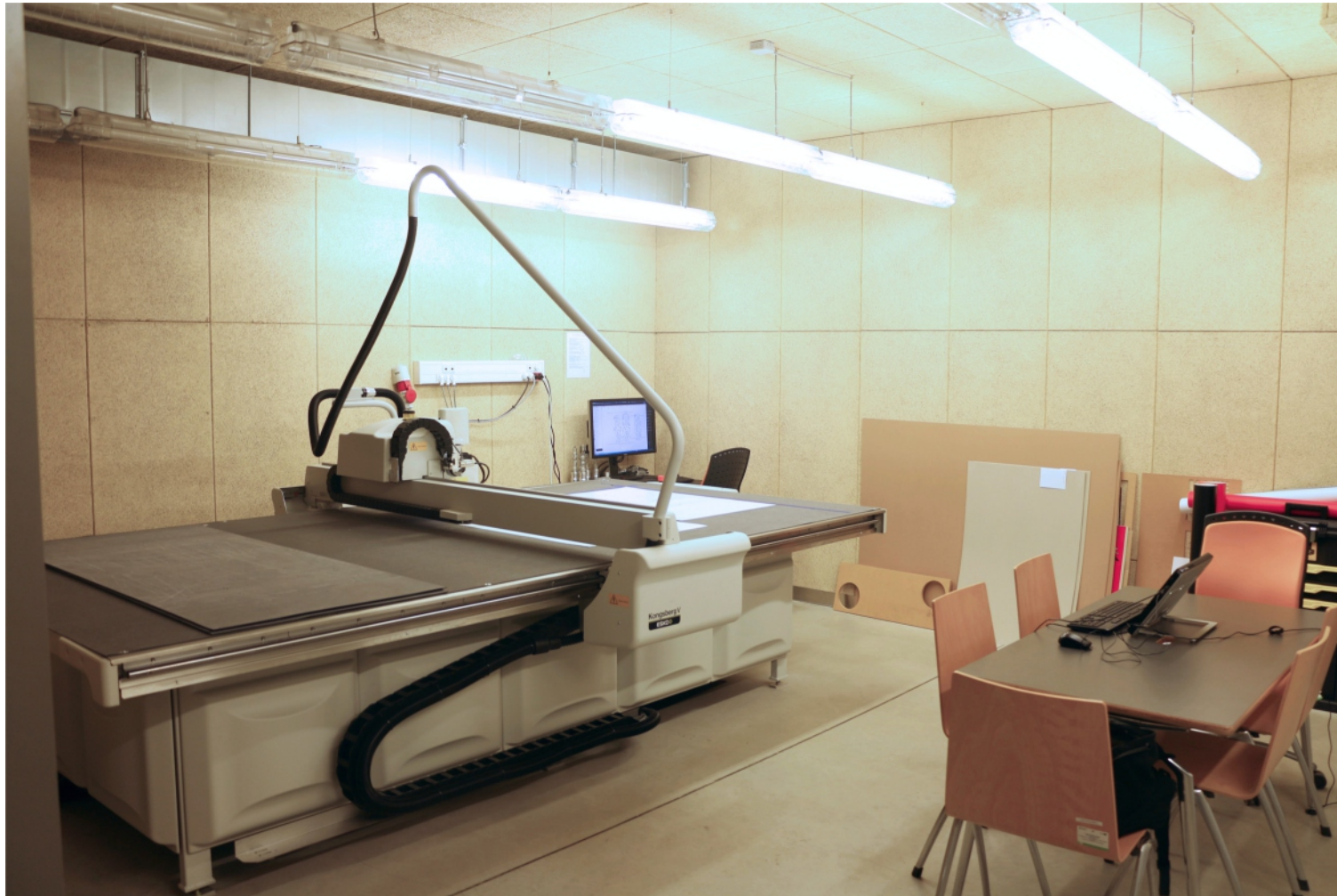
Konsberg V - ploter tnąco frezujący, wielkoformatowy (oprogramowanie Artios CAD)
