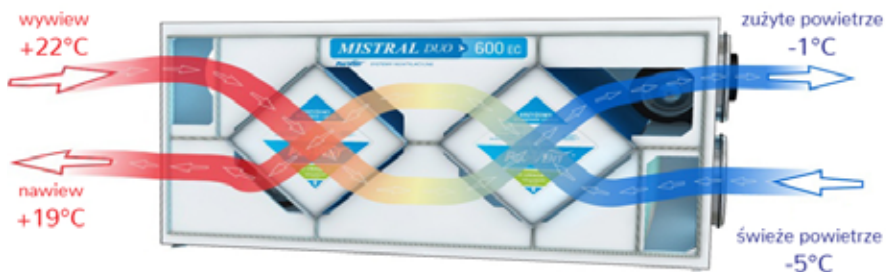
Rys. 8. Schemat przedstawiający zasadę działania rekuperatora
